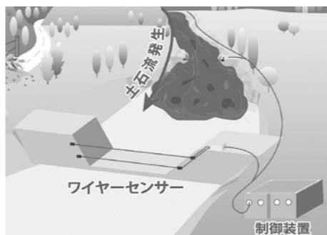
ワイヤー式土石流センサーの模式図
