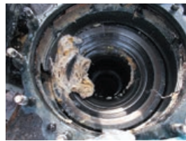
故障したマンホールポンプ マンホールポンプのなかで布がからまっている
