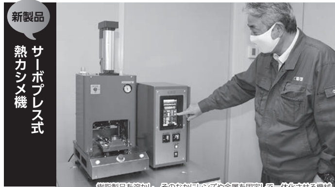
樹脂製品を溶かし、そのなかにレンズや金属を固定して一体化させる機械。より高機能の熱力シメ機を求めるメーカーニーズに応えた製品が完成した。
