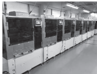
全自動レンズ組み立てライン
