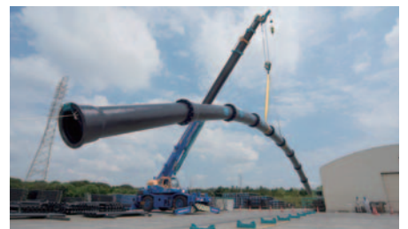
水道管をクレーンで吊り上げる実験。これだけしなくても破損しません(提供：日本ダクタイル鉄管協会)
