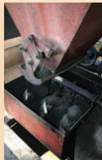
市営の常温アスファルトプラント。自前の工場で舗装材をつくるため、細やかな対応が可能
