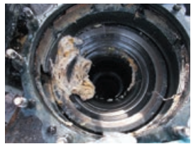
故障したマンホールポンプ マンホールポンプのなかで布がからまっている
