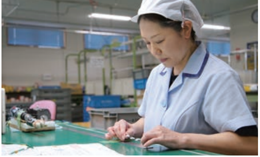
多品種のワイヤーハーネスを扱いますが、それぞれ組み上げ方が違うので、図面を見ながら正確に迅速に作業を進めます
