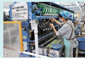
自動繰糸機では、サンゴやクラゲの遺伝子を組み換えてつくられた蛍光色に光る繭から糸を繰糸中
