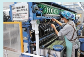
自動繰糸機では、サンゴやクラゲ の遺伝子を組み換えにつくられた 蛍光色に光る繭から糸を繰系中
