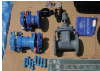
災害に強くサビの出ない耐震型高性能ポリエチレン管、継手はエポキシ樹脂粉体塗装が主流
