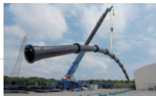
震災を教訓に耐震性にすぐれた耐震型ダクタイル鋳鉄管も普及。岡谷市もこれを採用している
