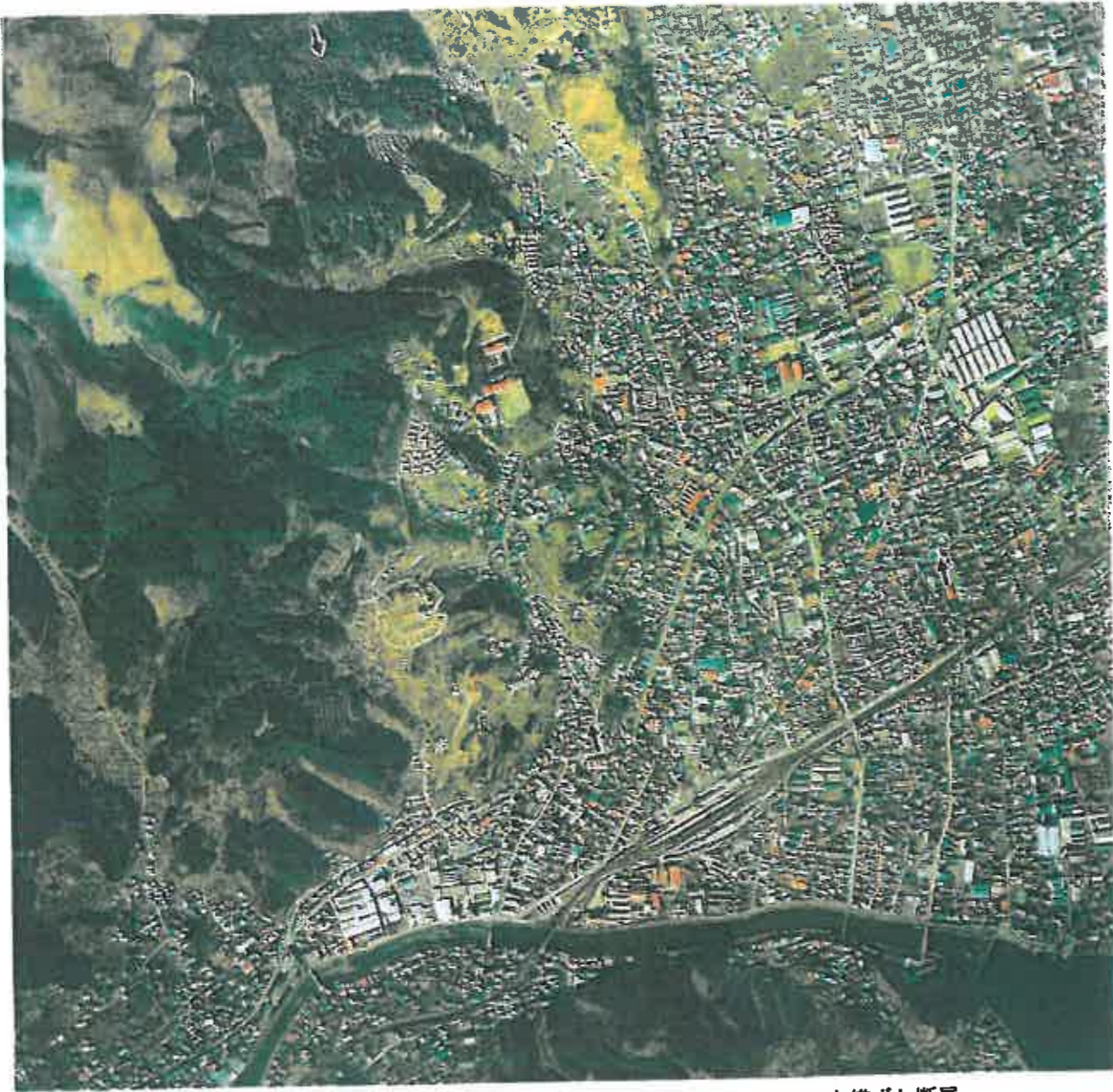
JR岡谷駅を中心とした岡谷市街地の空中写真。左上に向かって、左横ずれ断層が走っている。矢印は断層の方向。右下が諏訪湖の釜口水門（1975年撮影）
