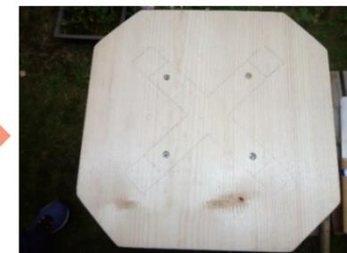
印を付けた部分に下穴ドリル加工ダボ穴加工、ビス(25mm)を入れて天板と脚をくっつける
