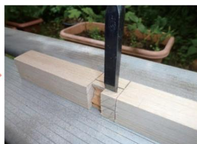
貫の溝の部分をノミで削る×4
