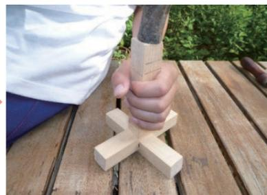
溝の部分にボンドをぬり上部の貫を作る
