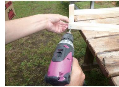
i 脚用木材と上部の貫を取り付ける。ビス下穴をドリルで加工する
