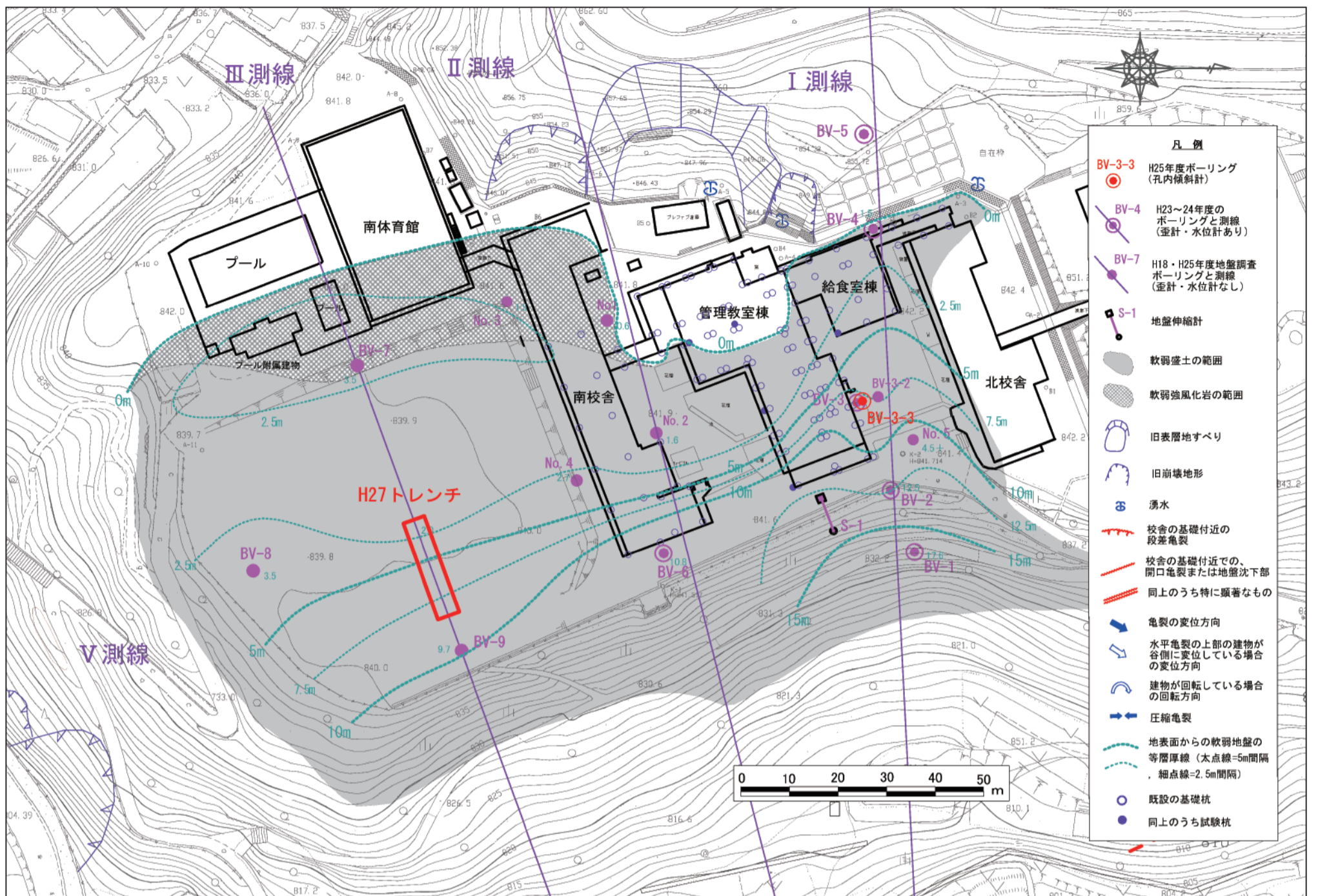
校庭トレンチ調査結果による軟弱地盤の分布図
