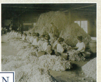
N 山共岡谷製糸の選繭場 良質な原料繭を確保することが、製糸業にとっては重要であった。製糸家たちは明治期から県外へ原料繭を求めて進出していった。写真は工女一人一人の手によって繭を選り分けている様子。
