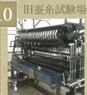
昭和22年、農林省蚕糸試験場岡谷製糸試験所として設置され、日本における製糸技術研究の重要な拠点となつた。自動繰糸機を中心とした繭乾燥から製糸まで一連の生産機械が残され、多条繰糸機等が認定を受けている。多条繰糸機は現在も製糸工場内で稼働している。
