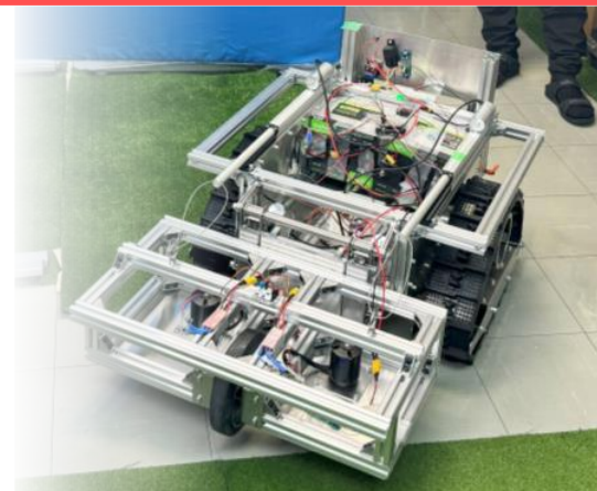
傾斜部畦畔の草刈りロボットのオール電気化の開発（R5採択）
