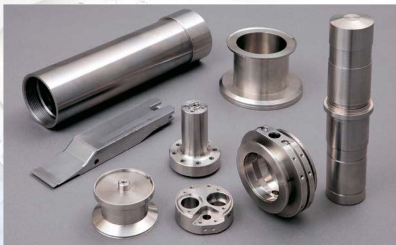
難削材切削加工(ステンレス鋼全般、インコネル、ハステロイ 他)
