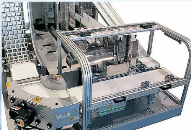
コンベヤシステム (高速合流ユニット) Conveyor system (example high-speed confluence unit)
