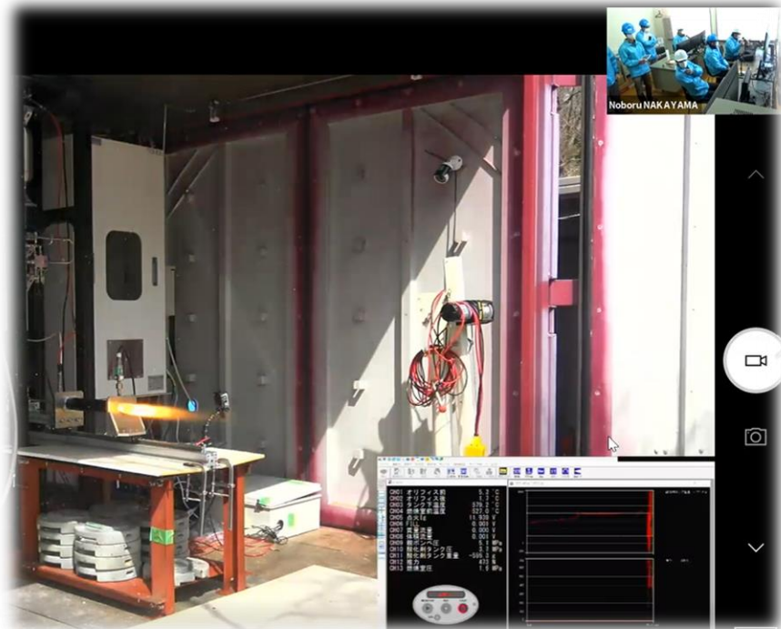
【令和3年3月20日】 ロケットが音速を超えるための新型ハイブリッドエンジンを試作し、燃焼実験を実施。
