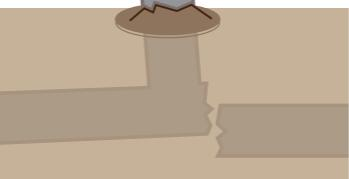
地下タンク・埋設管・マンホール等の地中の構造物が浮き上がることがあります。
