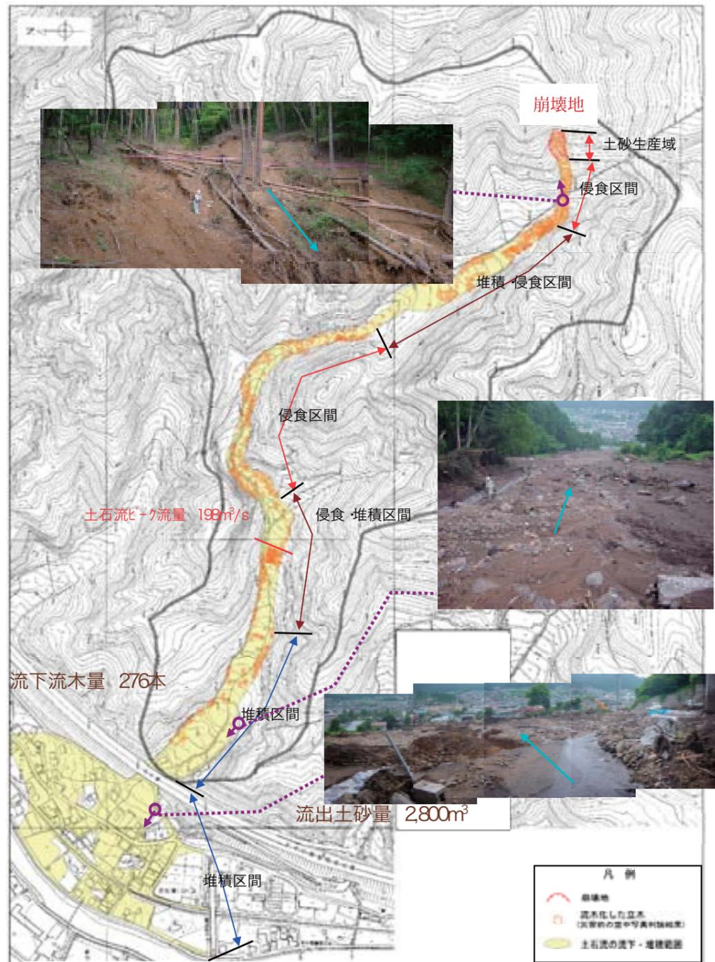
図 2-1 土石流の流下実態 (志平川)
